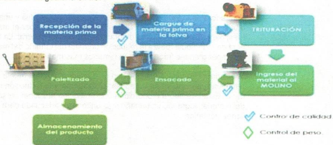
Ilustración 1 Diagrama de las etapas del proceso productivo de la empresa Minerales Micronizados del Magdalena S.A.S.
