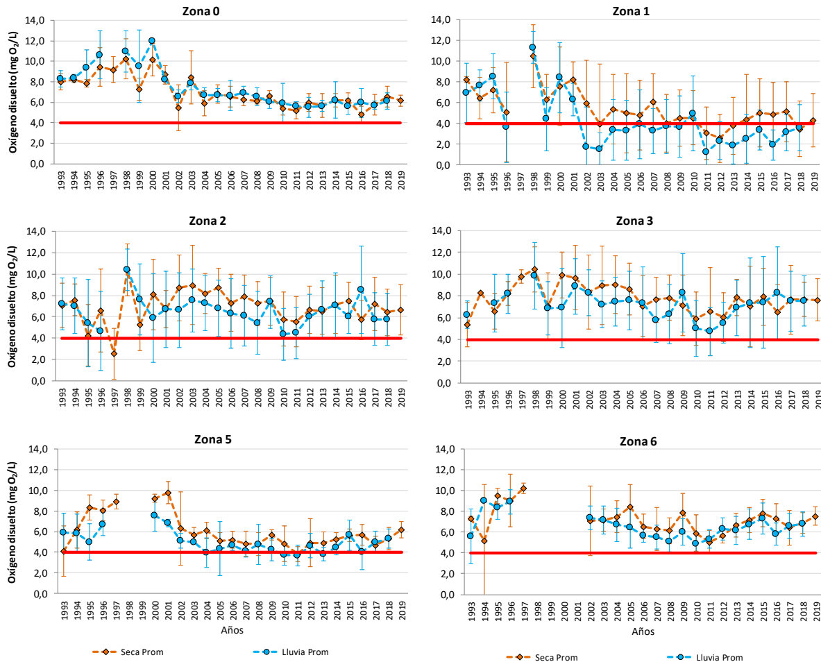
Figura 4.1-10. Registros históricos (1993 - 2019) del oxígeno disuelto (mg O 2 /L) promedio del agua superficial en seis zonas de la CGSM. Puntos naranjas representan la época seca y puntos azules la época lluviosa. Líneas verticales representan la desviación estándar. Línea horizontal roja representa el límite mínimo permisible para preservación de flora y fauna (4,0 mg O 2 /L; MinAmbiente, 2015 ).
