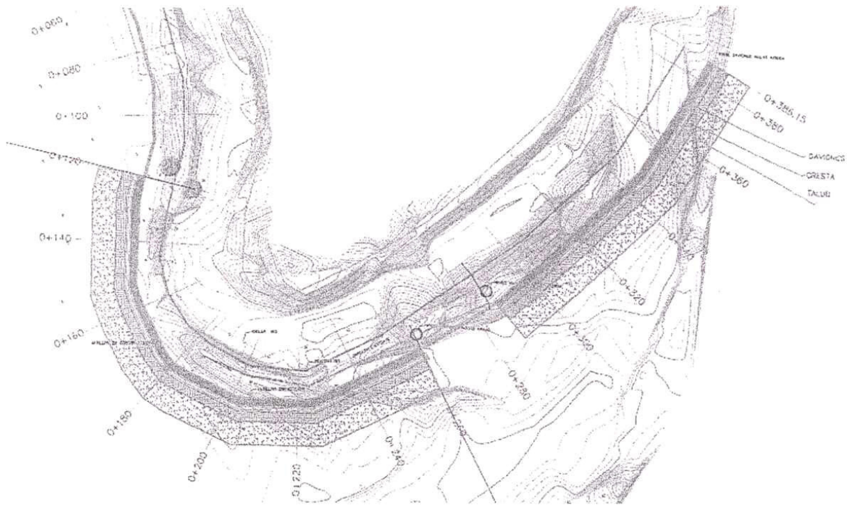
Figura 3. Planta general de la protección con gaviones.
