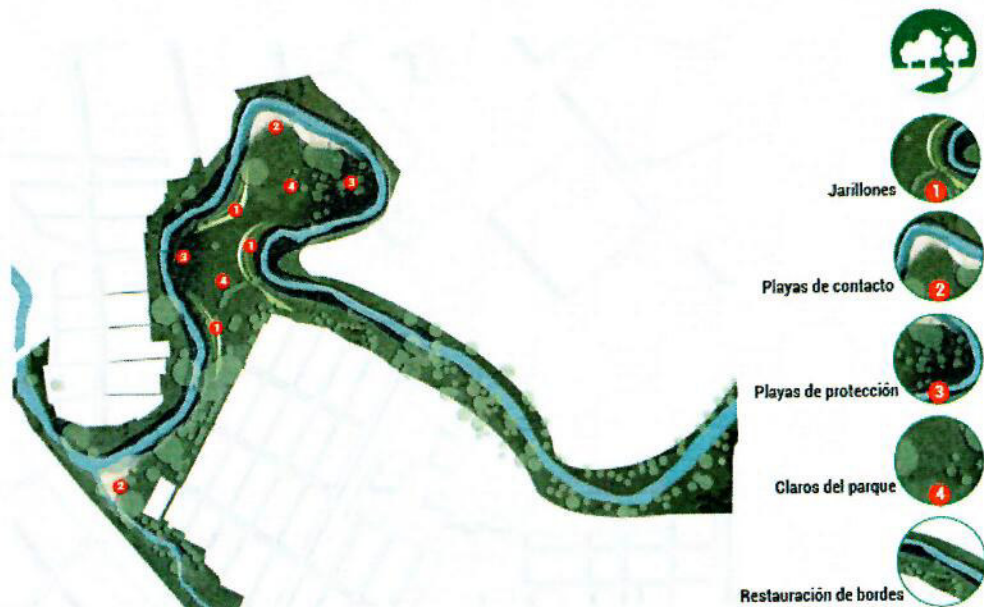
Ilustración 23. Estrategias de Intervención de las orillas para la recuperación ambiental del río. Fuente: Propia.
